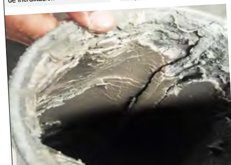
Sin Vulcan, el filtro se atascaba rápidamente por los depósitos calcáreos y tenía que cambiarse cada 48 horas.
