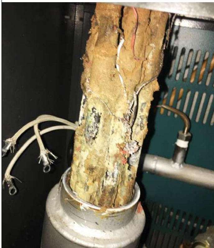
Intercambiador de calor sin mantenimiento por 3 años.
