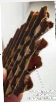
El agua proviene de un pozo subterráneo. Se instaló una unidad Vulcan S500 tras limpiar la placa del intercambiador de calor. Luego de 4 meses no se observaban más depósitos de cal blancos y solo quedaba óxido amarillento. Aunque aún habían sustancias en la placa, estas se ablandaron.
