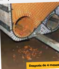
El agua proviene de un pozo subterráneo. Se instaló una unidad Vulcan S500 tras limpiar la placa del intercambiador de calor. Luego de 4 meses no se observaban más depósitos de cal blancos y solo quedaba óxido amarillento. Aunque aún habían sustancias en la placa, estas se ablandaron.
