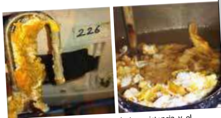
Fotos 2 y 3. Antes la cal cubría la resistencia y el sumidero (la fotografía se tomó en una de las cuartos del hotel IBMA).
