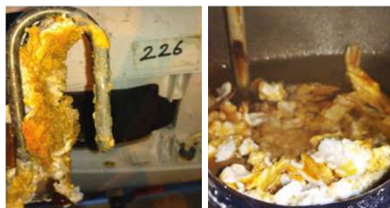
Fotos 2 y 3. Antes la cal cubría la resistencia y el sumidero (la fotografía se tomó en una de los cuartos del hotel IBMA).
