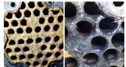
Tubo - intercambiador de calor
