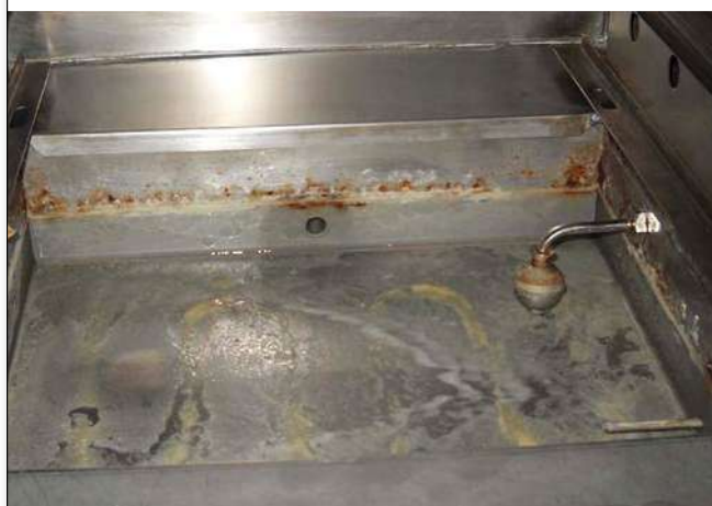
Pfanne vor dem Einbau von Vulcan, harter Kalk und geätzte Linien vorhanden.
