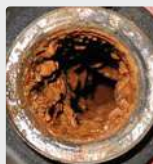
Biopelícula en un sistema de tuberías
