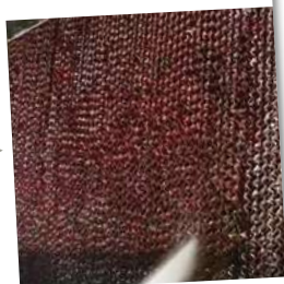
Después de 2 semanas de la instalación del equipo Vulcan S10, la antigua cal se había suavizado y la nueva se había formado como polvo. Los nuevos depósitos de cal se eliminaron con facilidad y los antiguos fueron más fáciles de eliminar con una pistola de agua.
