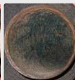
Kalk mit Biofilm im Rohr
