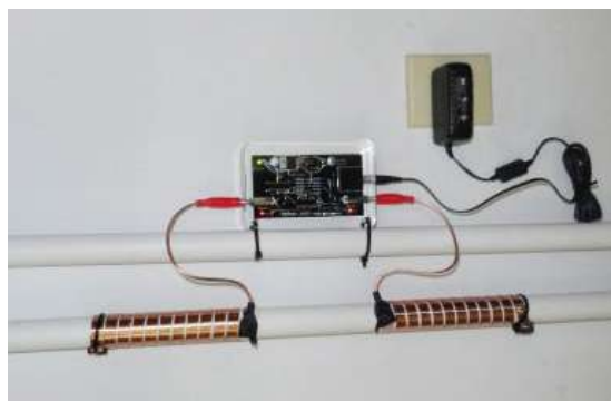
Fig. 4: Disposición básica del tratamiento físico del agua
