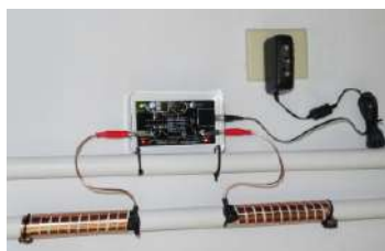
Bild 4: Grundsätzliche Anordnung zur physikalischen Wasserbehandlung
