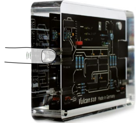
Berühren Sie beide Metallplatten, um das Programm einzustellen
