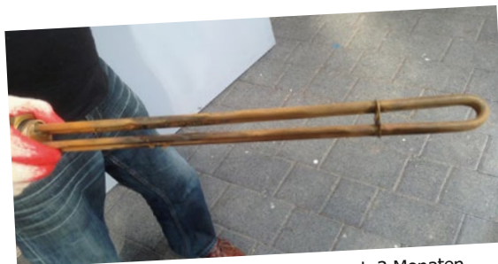
Kalkablagerungen vollständig entfernt nach 3 Monaten.
