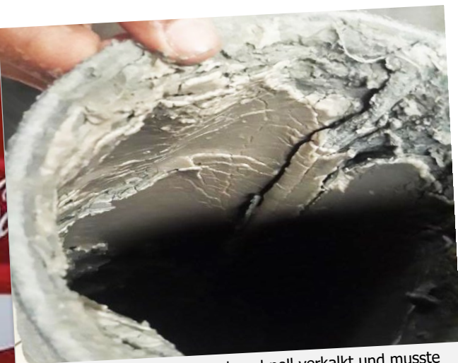
Vor der Vulcan Installation: Die Rohre sind voller Kalk
