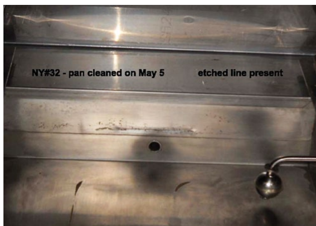
Nach dem Einbau von Vulcan ist der Bereich der Wanne jetzt völlig frei von Kalk. Es gibt eine leichte Vertiefung in der Pfanne an der Wasserlinie.
