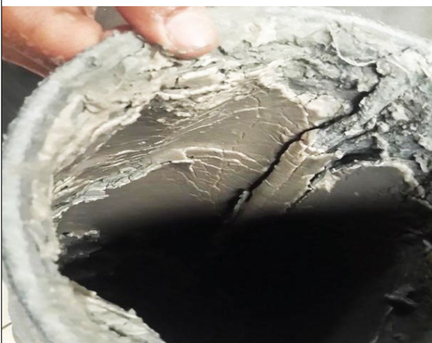
Ohne Vulcan war der Filter sehr schnell verkalkt und musste alle 2 Tage getauscht werden.
