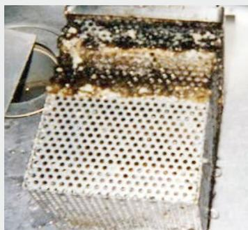
Estado después de una utilización sin limpieza desde la instalación en junio (no se observan materiales adheridos en las partes que están en contacto con el agua).
