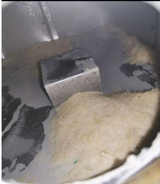
Le calcaire s'est complètement transformé en poudre et il n'est plus nécessaire d'ouvrir le cuiseur-vapeur pour le nettoyer puisque la fonction habituelle d'évacuation fonctionne à présent parfaitement. Le réservoir d'eau chaude est désormais propre et sans calcaire. En raison de ces résultats probants, nous allons poursuivre notre coopération avec l'hôtel afin de traiter son système d'alimentation en eau chaude et son système de climatisation général.
