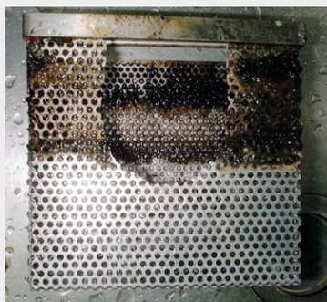
La canasta después del lavado con una manguera. Las partes que normalmente están en contacto con el agua tratada se limpian fácilmente con un chorro de agua del grifo.
