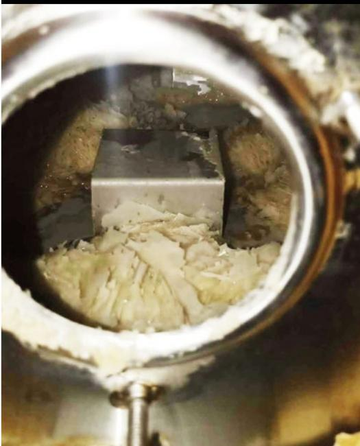
Der Kalk war flockig und konnte nicht aus dem Abflussloch des Dampfgeräts abgelassen werden. Um die Effektivität des Vulcan-Systems zu testen, wurde kein Reinigungsprozess vor der Installation des Vulcan S10 durchgeführt.
