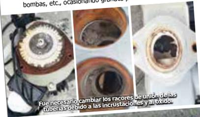
Fue necesario cambiar los racores de unión de las tuberías debido a las incrustaciones y al óxido.
