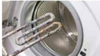
Resistencia calentadora de una lavadora
