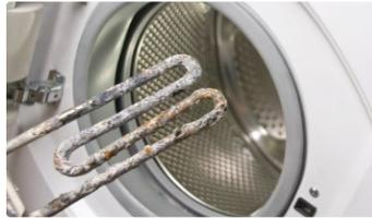
Heizelement einer Waschmaschine
